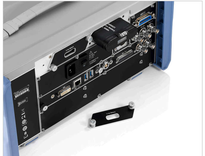
R&S®ZNL 后视图，含电池盒。用户可以轻松装卸电池。
